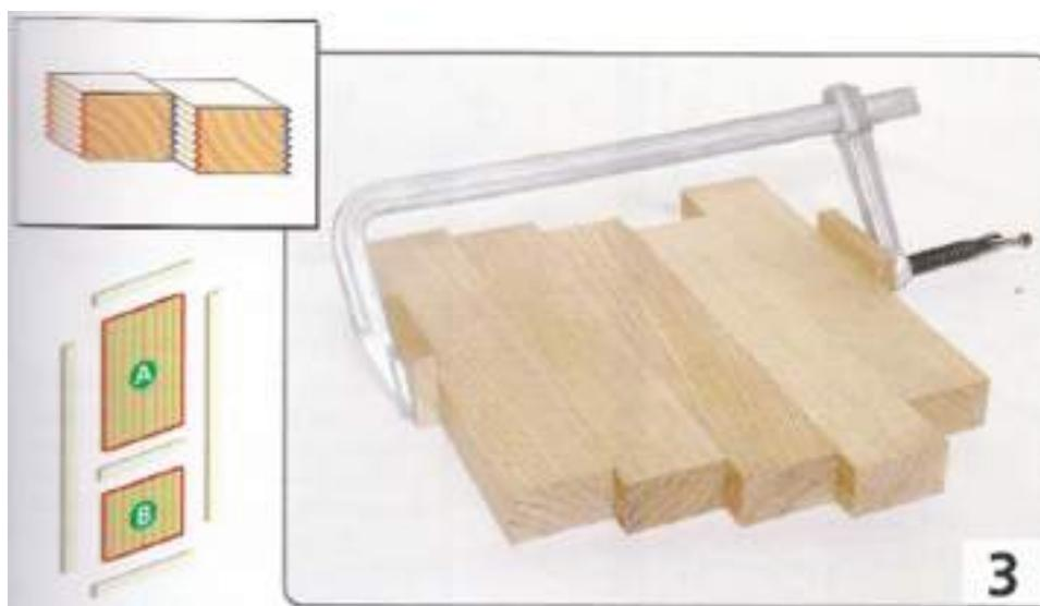
3. Montar e colar todas as peças maquinadas, fixando-as firmemente com um grampo. No momento de unir as peças, verificar que o veio de cada peça fica de frente em direções opostas.
