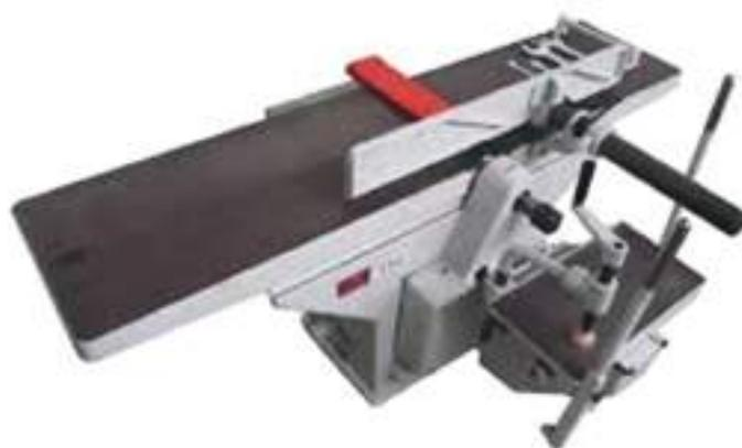
Esta máquina é constituída por um corpo blindado que suporta uma mesa de entrada e outra de saída entre as quais se encontram um cilindro porta-lâminas coberto por um resguardo. Normalmente, a mesa de saída está fixa e a mesa de entrada é regulável verticalmente, através de um punho regulador determinando assim a profundidade de corte.
